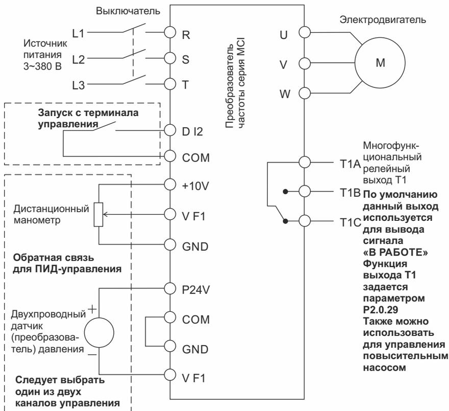
Замечание: Если используется дистанционный манометр, переключатель J5-1 (DIP переключатель входной клеммы VF1) должен находиться в положении U, если применяется датчик давления, переключатель J5-1 должен находиться в положении I.
