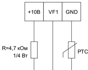
Режим работы: при снижении напряжения на входе с датчика менее 0.04В считается короткое замыкание датчика PTC, преобразователь частоты останавливается и высвечивается авария "Err21", при увеличении напряжения на входе с датчика PTC более 4,00В означает перегрев двигателя, преобразователь частоты останавливается и высвечивается авария "Err21".
