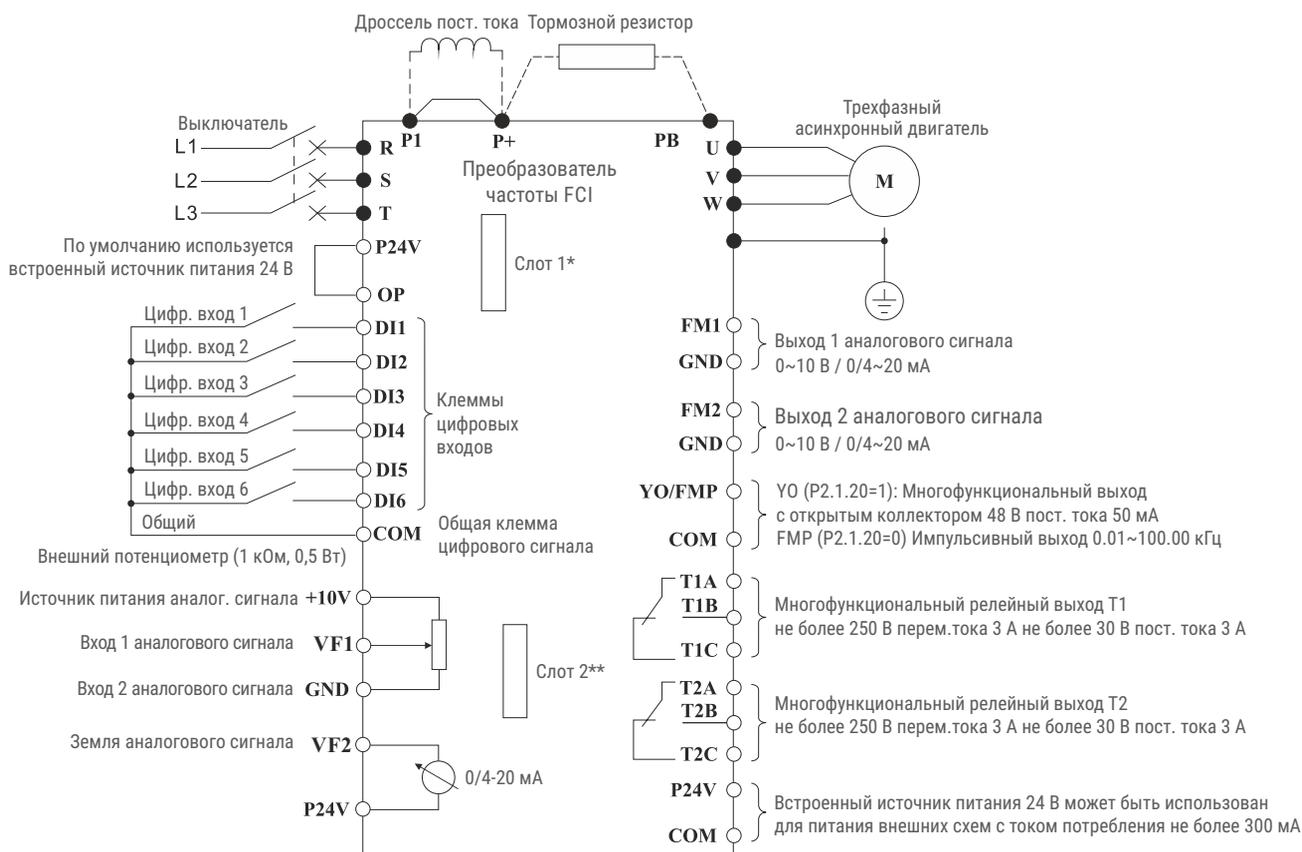
Стандартная конфигурация для преобразователей частоты мощностью от 18,5 кВт (по режиму G)
